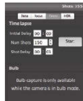
Zeitraffer: Mit den hier gezeigten Einstellungen entsteht nach dem Druck auf den Start-Button eine Serie von 150 Bildern. Zwischen zwei Bildern bleibt jeweils eine Pause von einer Sekunde.
