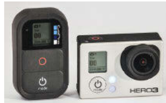
Die Kamera und die Fernbedienung haben ein identisches Menüdisplay und die gleichen Bedienungsknöpfe. Die Displays zeigen simultan an, weil die Kamera Daten auch zurück an die Fernbedienung sendet. Die blaue Diode zeigt den WiFi-Kontakt an. Die Fernbedienung ist übrigens auch bis drei Meter wasserdicht.
