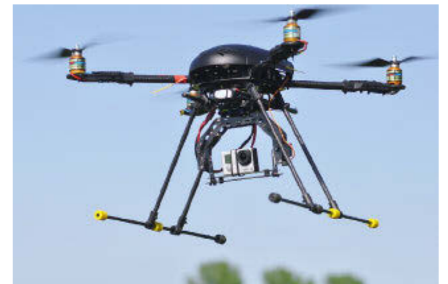
Ohne Gehäuse wiegt die GoPro nur rund 75 Gramm, mit Gehäuse sind es rund 140 Gramm. Eine ganze Reihe aktuell verfügbarer Quadrocopter sind in der Lage, solche Gewichte zu tragen und dadurch eröffnen sich auch für Naturfotografen höchst interessante Optionen, Bilder aus nicht ganz alltäglichen Perspektiven aufzunehmen. Entsprechend „tragfähige“ Flugobjekte gibt es bereits für unter 300 € (z.B. www.multicopter-shop.de , www.conrad.de , www.studiosport.fr ).
