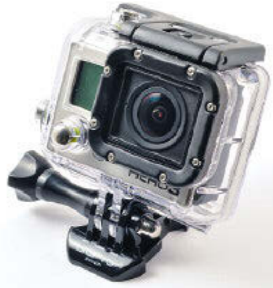
Die Kamera in dem Unterwassergehäuse, das bis 60 m dicht ist. Das Gehäuse sollte man möglichst auch „an Land“ zum Schutz der Linse verwenden. Wie bei allen kompakten digitalen Kameras ruiniert jeder noch so kleine Kratzer das Objektiv – wegen der extrem kurzen Brennweite wird er zwar unscharf, aber deutlich abgebildet. Das Schutzgehäuse verhindert eine Beschädigung zuverlässig und das „Objektiv“ des Gehäuses ist plan, wirkt sich optisch nicht aus und kann als Ersatzteil ausgetauscht werden. Die beiden Bedienungsknöpfe (sowie auch der Ein/Ausschalter für WiFi) können manuell von außen betätigt werden, außerdem hat man ja die Fernbedienung.
